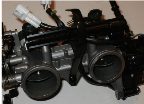
*Déposer le passe fil et sa vis du support de la platine d'arrêt de gaine d'accélérateur.*
