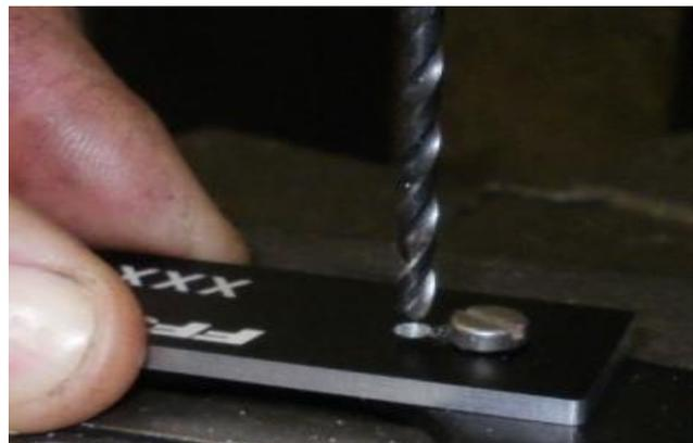
**Déposer le calibre et achever le trou avec un forêt de 3,2 mm.
