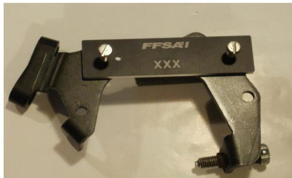
***A l'aide du forêt de 3 mm, percer le support d'arrêt de gaine dans le trou de référence du calibre***
