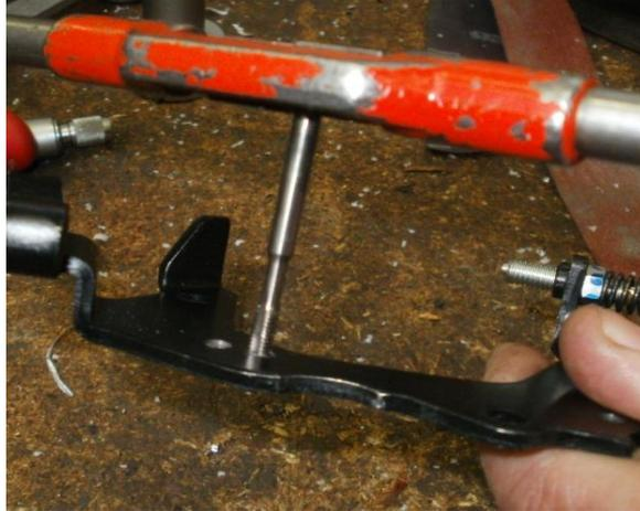
**Positionner la bague bronze et serrer la vis Allen après avoir préalablement déposé une goutte de frein filet.**
