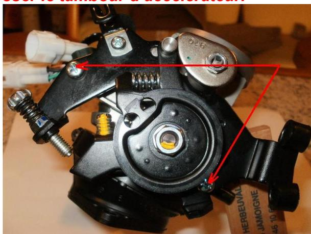
***Vue du support d'arrêt de gaine déposée.***
